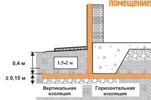
Рис. 4. Теплоизоляция фундамента с нерегулярно отапливаемым помещением
