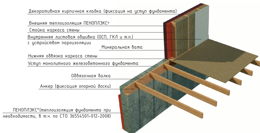
Рис.18. Вариант закрепления элементов каркаса нижнего перекрытия на уступе фундамента/цоколя (монолитный железобетон) при помощи опорной доски (анкерная фиксация).
