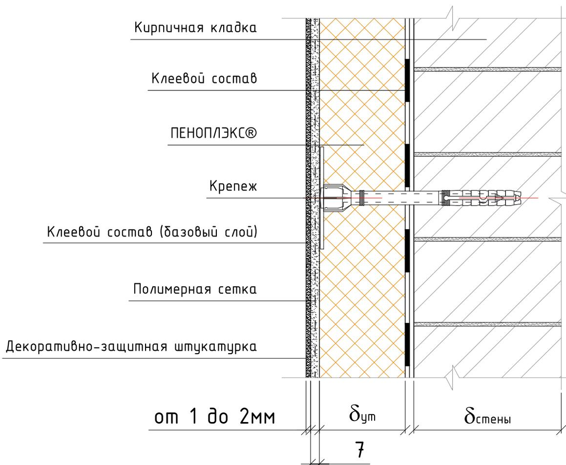
Рис. 2. Схема конструкции стены первого или цокольного этажа №2
