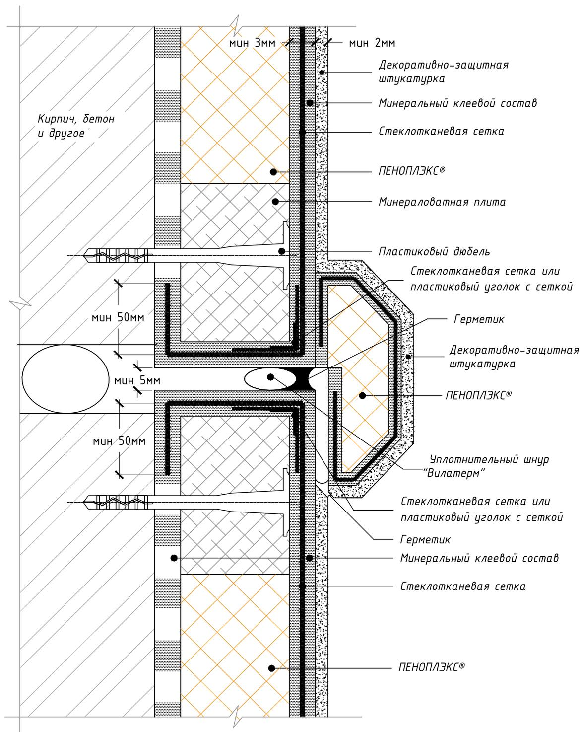
Рис. 7 Схема узла расположения деформационно-усадочного шва. Декоративный элемент.
