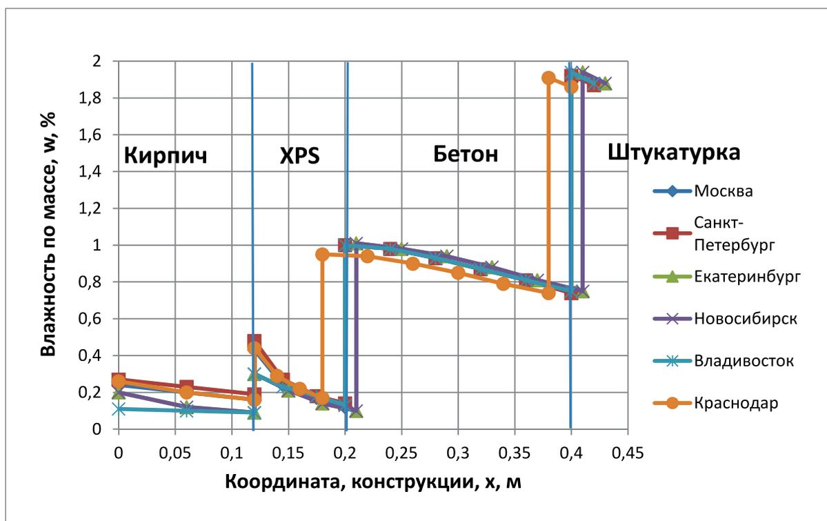
Рис. 12. Распределение влажности внутри конструкции №4 на начало февраля
