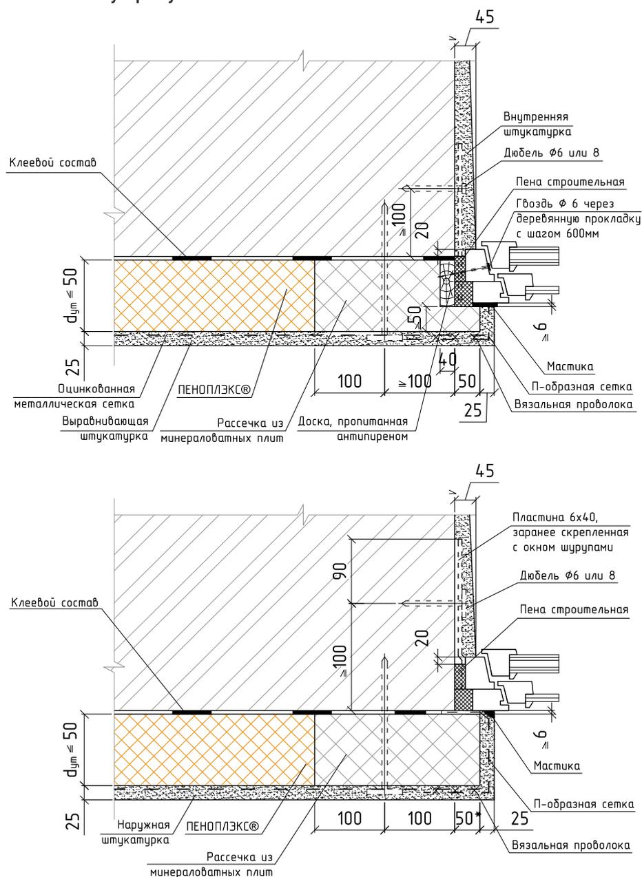
Рис. 2 Схема узла примыкания стены к оконному проему.
