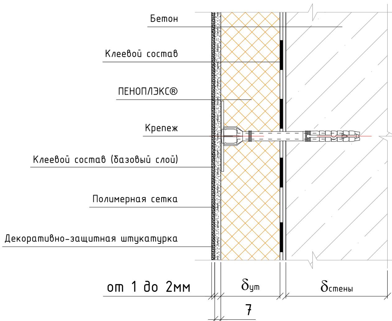
Рис. 1. Схема конструкции стены первого или цокольного этажа №1
