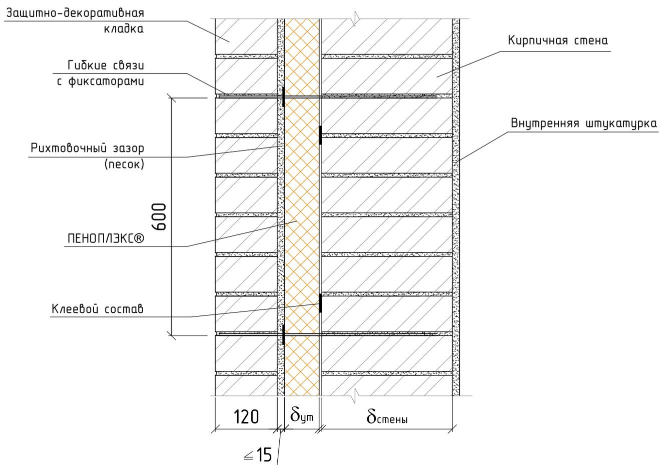
Рис. 5. Схема конструкции стены первого или цокольного этажа №5
