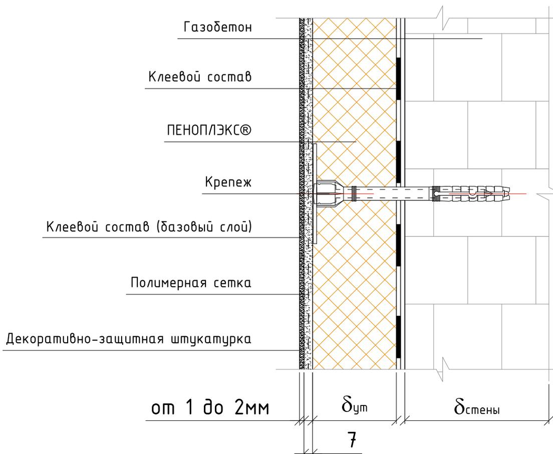
Рис. 3. Схема конструкции стены первого или цокольного этажа №3
