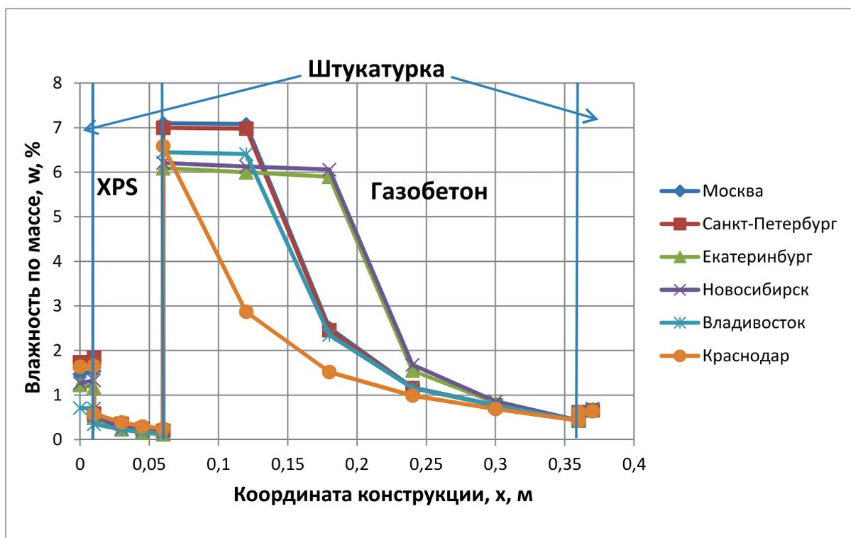
Рис. 10. Распределение влажности внутри конструкции №3 на начало февраля
