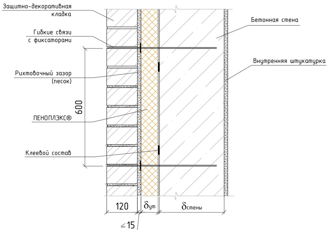
Рис. 4. Схема конструкции стены первого или цокольного этажа №4
