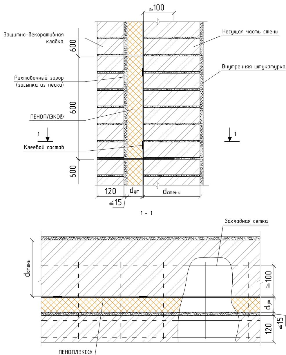
Рис. 5 Схема узла расположения сетки в стене.
