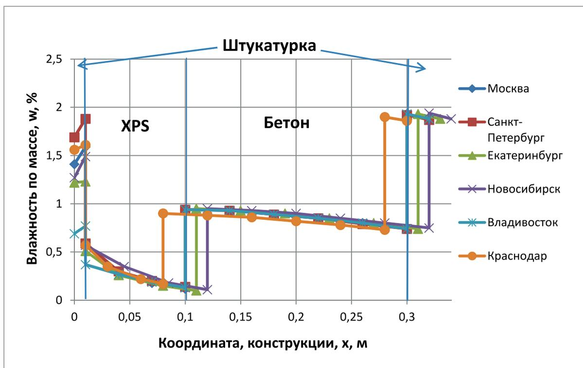
Рис. 6. Распределение влажности внутри конструкции №1 на начало февраля
