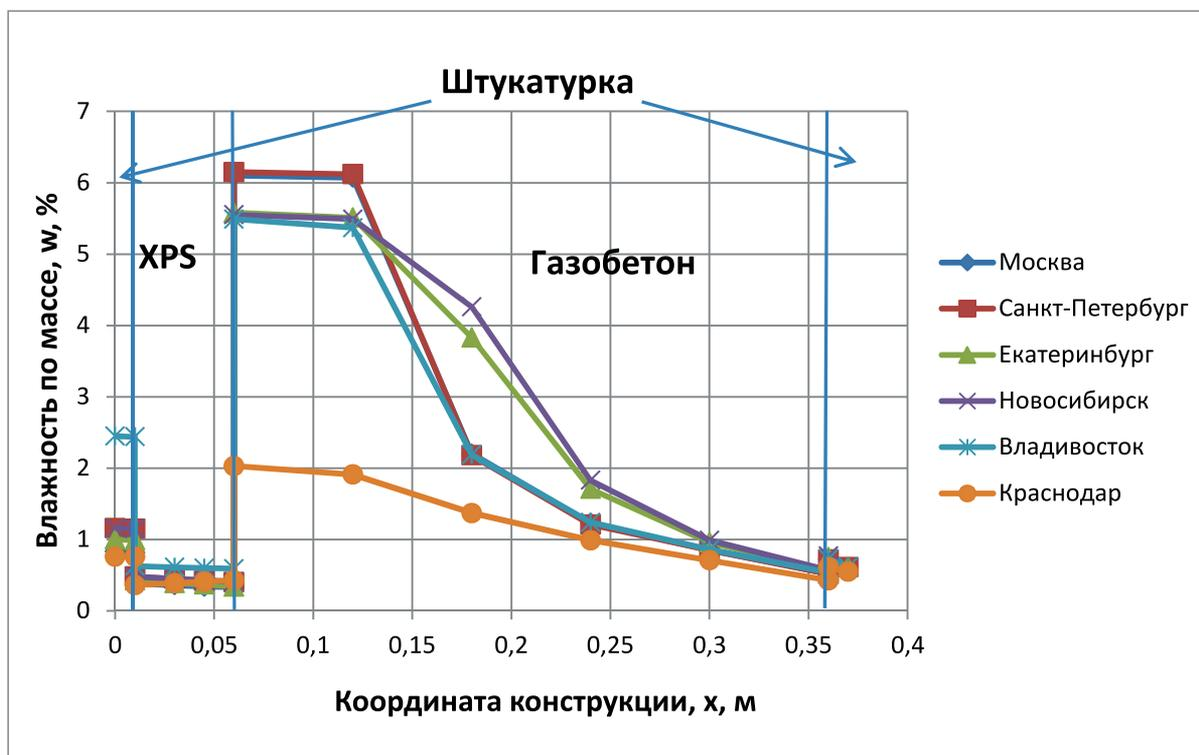
Рис. 11. Распределение влажности внутри конструкции №3 на начало августа
