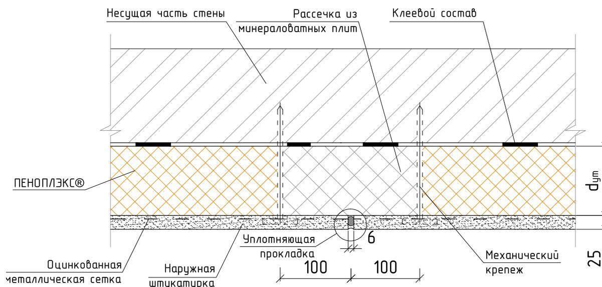
Рис. 1 Схема узла установки рассечки из минеральной ваты.
