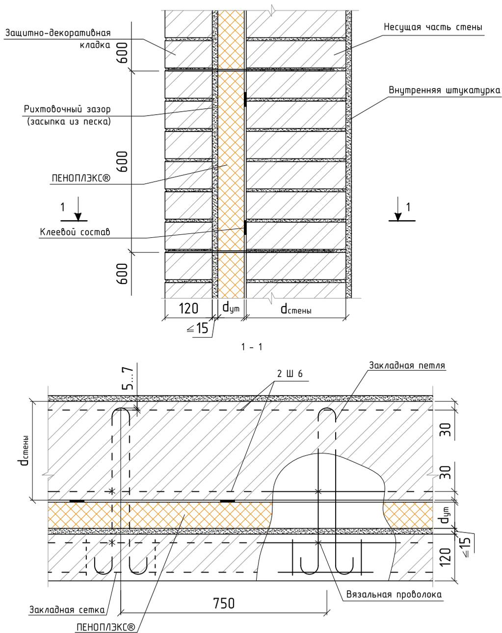
Рис. 4. Схема узла расположения петель в стене.
